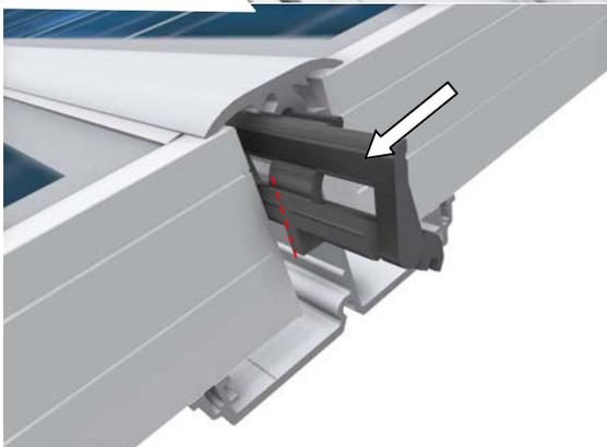
Das erste und letzte Modul einer Reihe, werden außen, zusätzlich mit einer Modulsicherung gesichert. Für die Montage muss der Hebel der Modulsicherung abgetrennt werden. Erst jetzt kann die Modulsicherung im eingerasteten Zustand seitlich in den oberen Schraubkanal eingehängt und hinter dem Modul platziert werden.
