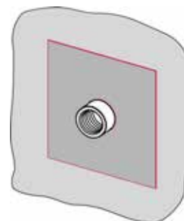
Bild 2: Dichtmanschette in noch feuchten Dichtanstrich einbetten
