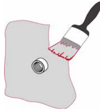
Bild 1: Aufbringen des unteren Dichtanstrichs
