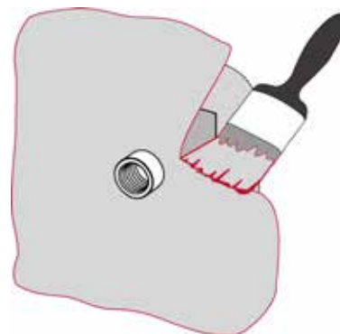
Bild 3: Aufbringen des oberen Dichtanstrichs
