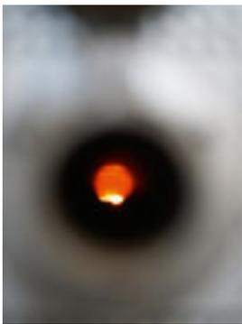
Die getrockneten und schon glasierten Rohlinge werden bei einer Temperatur von bis zu 1240°C gebrannt. Diese extremen Temperaturen beim Brennvorgang sorgen für den hohen Härtegrad- und Verschleißwiderstand der hochwertigen LAUFEN Produkte.
