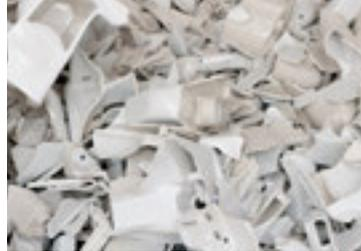
Keramik ist eines der ältesten plastischen Materialien der Menschheit – und besteht ausschließlich aus natürlich vorkommenden Rohstoffen. Keramik ist zu 100% recyclingfähig und kann als Mahlgut wieder dem Produktionsprozess zugeführt oder in anderen Industrien als wertvoller Rohstoff weiterverwendet werden.
