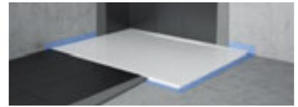
Das LAUFEN Installations-Kit aus Hartschaumstoff ermöglicht einen bodenebenen Einbau von zahlreichen Duschwannen – und unterstützt deren Schall- und Wärmedämmung. Ein umlaufendes Schutzband verhindert dauerhaft sicher das Eindringen von Wasser zwischen Fliesen und Duschwanne.
