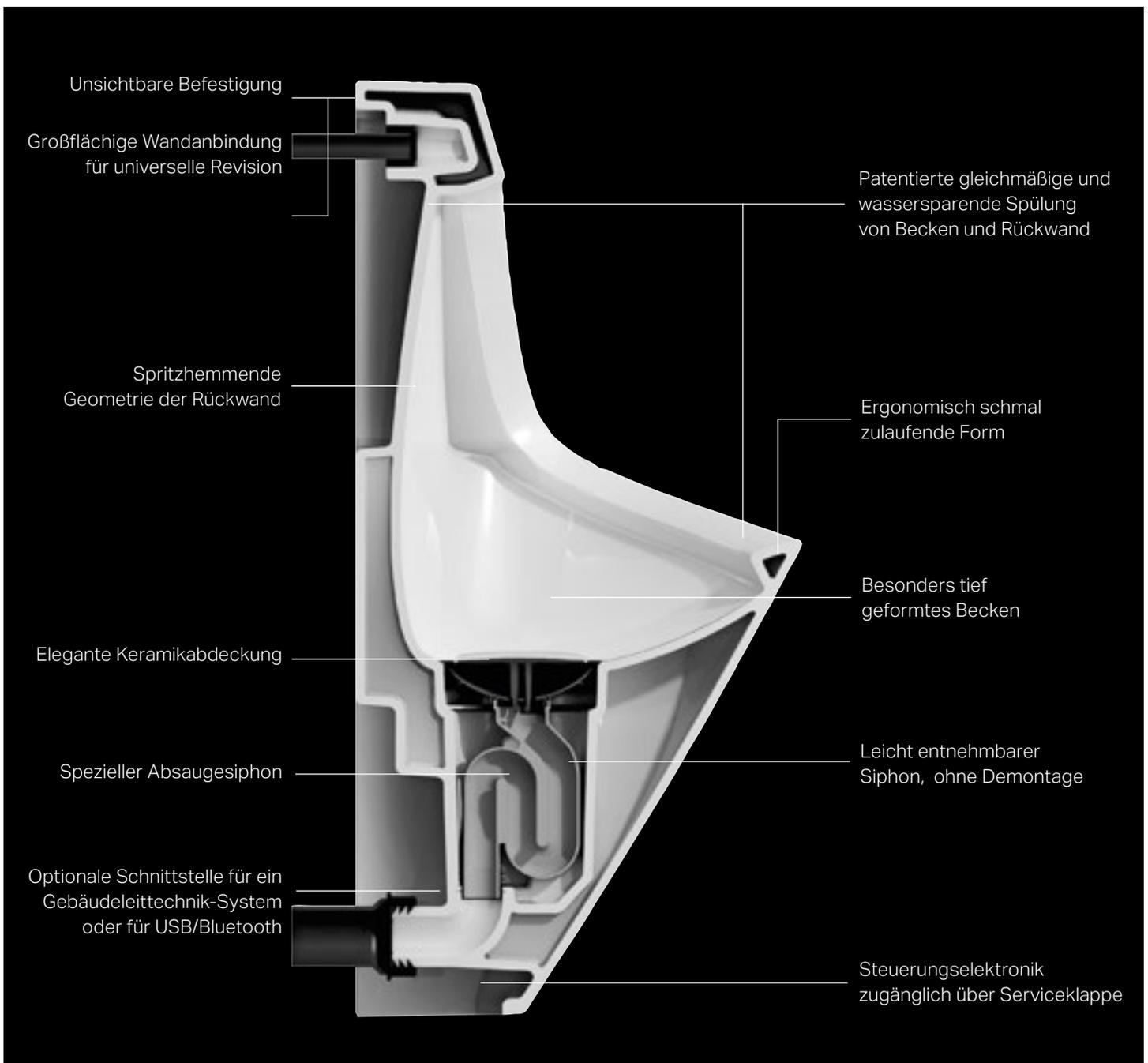
Ihre Genialität liegt in der Einfachheit. Bisher mussten Urinale beim Wechsel des Siphons häufig komplett demontiert werden. Bei ANTERO und LEMA lässt sich der Siphon einfach mit einem Spezialschlüssel lösen und herausheben.
