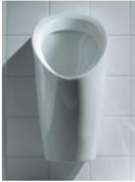
Das LAUFEN Lema 0-Liter-Urinal funktioniert ohne Wasser und benötigt weder eine Wassersperre noch Elektrizität, um den Abfluss geschlossen zu halten. Der Urin selbst hilft die Gase einzuschließen und verhindert ihr Ausströmen. Das Prinzip dieser «Falle» ist in der chemischen Industrie als Erlenmeyer-Gefäß bekannt. Das LAUFEN Lema 0-Liter-Urinal ist besonders geeignet wo der Zugang zu Frischwasser nicht direkt vorhanden, oder zumindest beschränkt ist.
