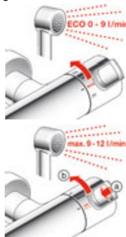
Eine leichte Drehung am Handgriff und die Wassermenge wird stufenlos reguliert. Mittels der Eco-Taste lässt sich zusätzlich komfortabel Wasser sparen. Wird der Eco-Bereich mit der Betätigung des Stoppknopfes verlassen, fließt die volle Wassermenge.
