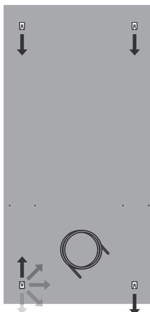
3. Kontrollieren Sie ob alle Wandhalter (V-Halter) Ihrer Heizung mit der Öffnung in eine Richtung zeigen. Falls nicht, richten Sie die V-Halter einheitlich in eine Richtung aus. In welche Richtung ist unerheblich.
