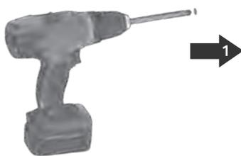
1. Bohren Sie als erstes die erforderlichen Löcher mit einem für den Werkstoff ihrer Wand geeigneten 8 mm Bohrer an den zuvor markierten Positionen.
