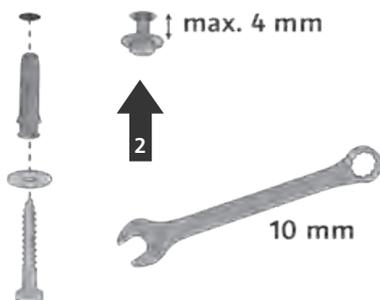
2. Verwenden Sie (sofern für den Werkstoff ihrer Wand geeignet) die mitgelieferten Dübel, die Schlüsselschrauben und die Unterlegscheiben aus dem der Heizung mitgelieferten „Standard-Befestigungsset“ – wie linksstehend abgebildet.
